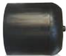
END CAP CALOTTA CODOLO LUNGO PE 100 SDR17 - ISO S8 (Gas) PN 10 (H2O)
